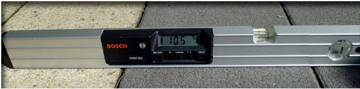
Abbildung: Steigungsmesser zur Überprüfung der Prozentzahl einer Steigung
